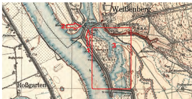
Na Liwie/ Alte Nogat, powyżej wrót powodziowych, utworzono zbiornik retencyjny gromadzący wody płynące tą rzeką na czas zamknięcia jazu piętrzącego
